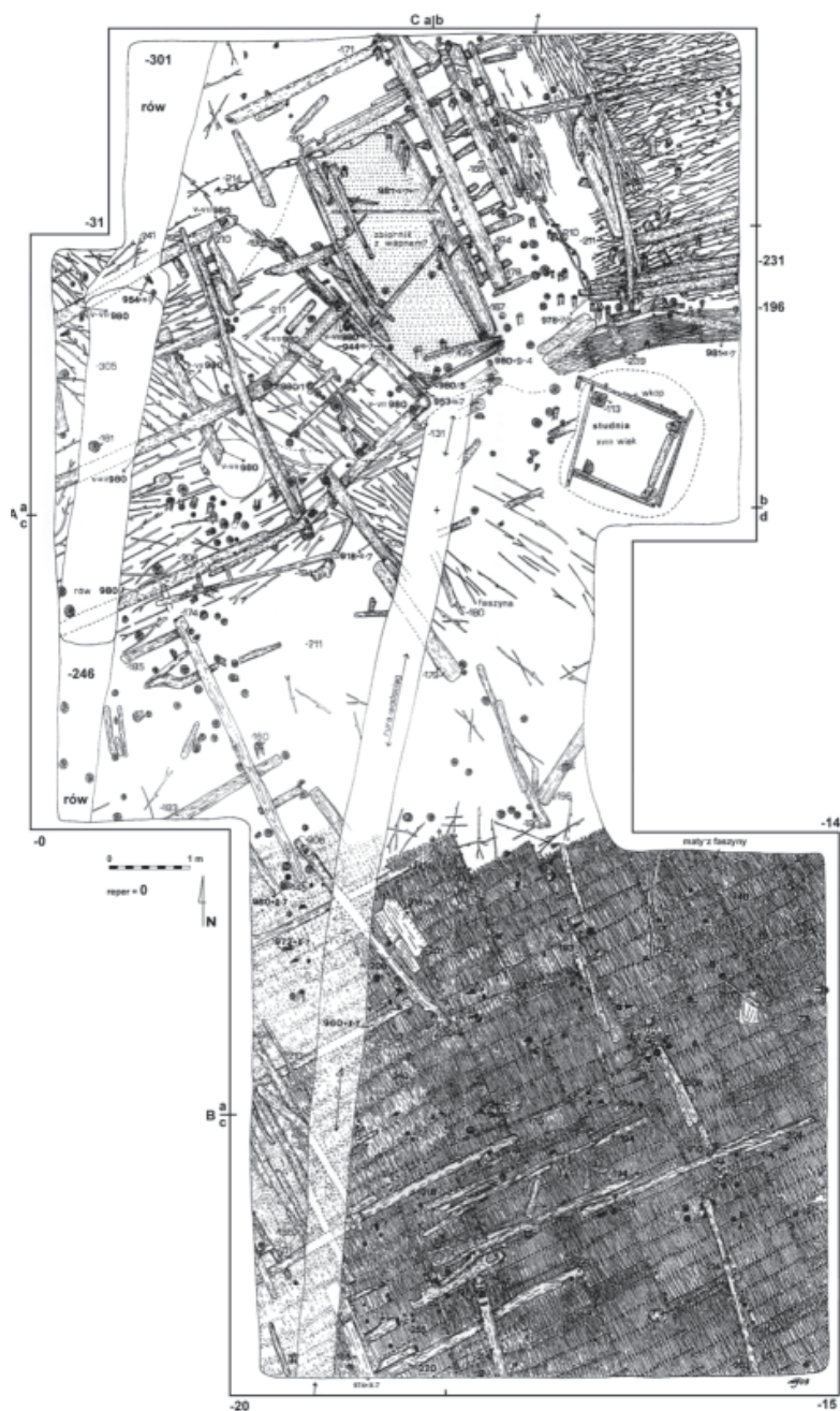
Ryc. 20. Wolin – dzielnica Ogrody, wykop nr 5, warstwy VII-IV: rzut poziomy konstrukcji drewnianych (rys. M. Jusza) Fig. 20. Wolin – the Ogrody quarter, trench 5, layers VII-IV: ground plan of wooden structures (drawing M. Jusza)
